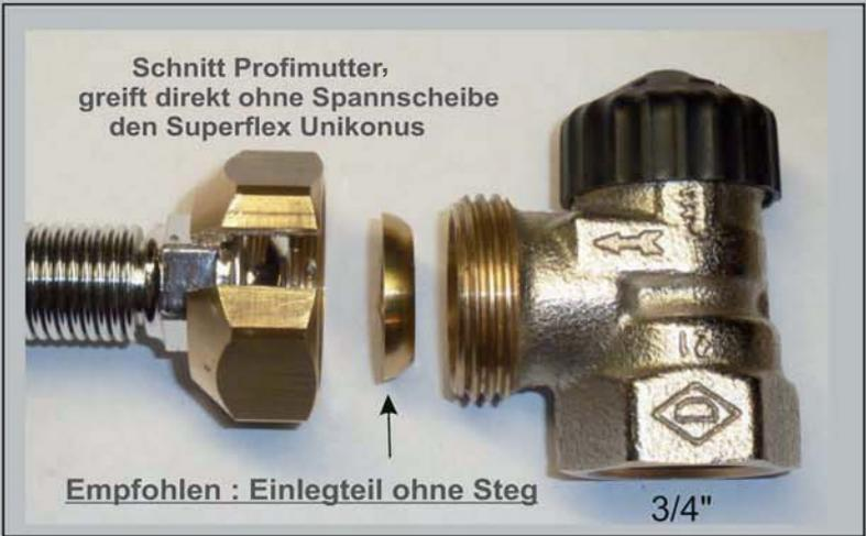
Profimutter über Superflex schieben, passenden Doppelkonus in das Ventil einlegen. Überwurf-Mutter mit Armaturenzange anziehen. Nicht verkratzen. Achtung: Es sind unterschiedliche Ausführungen von HK-Ventilen vorhanden. Sorgfältige Passung und Dichtigkeitsprüfung durchführen. Superflex gegenhalten!
